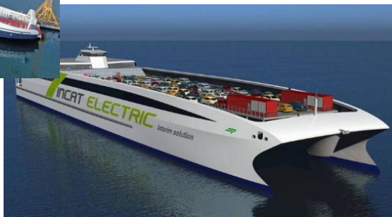
Catamaran électrique d'Incat Batterie 40 MWh
