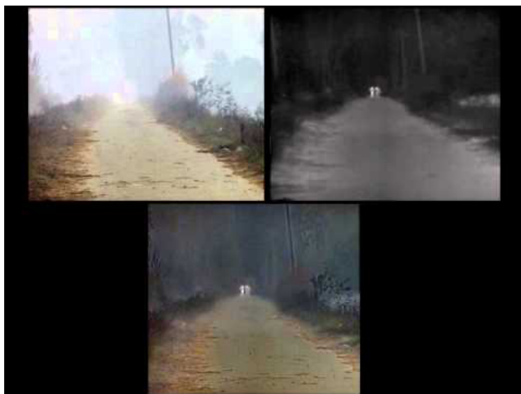
Figure 1 : caméra couleur, caméra thermique et fusion des deux images pour mettre en évidence les deux personnes
